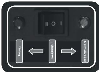
Если необходимо установить время работы дегидратора — переведите выключатель в положение «II» и установите время работы соответствующим регулятором.
